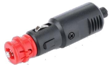
Zur festen Installation mit dem mitgelieferten Standardkabel muss der Zigarettenanzünderstecker entfernt (d.h. abgeschnitten) werden, während der Molex-Stecker am Kabel verbleibt. Das Zündkabel (**schwarz**) und das Massekabel (**braun**) müssen getrennt werden und alle drei Adern des Kabels müssen fest im Fahrzeug an den jeweiligen Kontakten im Fahrzeug installiert werden (Klemme 15 = Zündung = **schwarz**, Klemme 30 = Plus = **rot** und Klemme 31 = Masse = **braun**).
